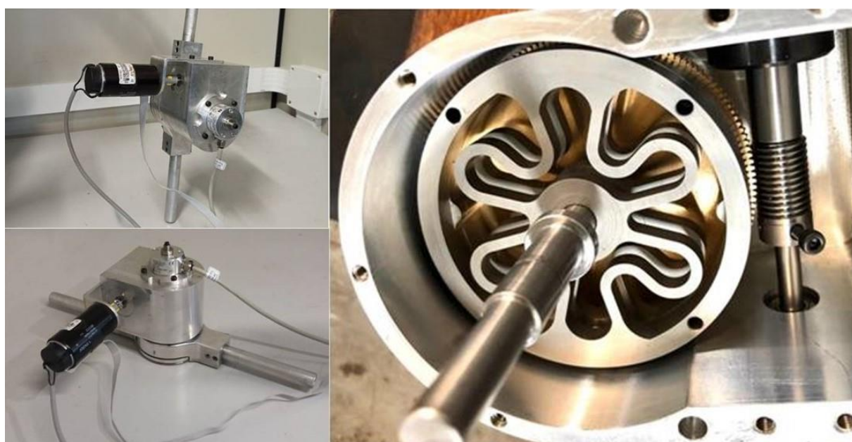
Figura 17 – Atuador usinado e acoplado à junta do exoesqueleto ExoTAO.
